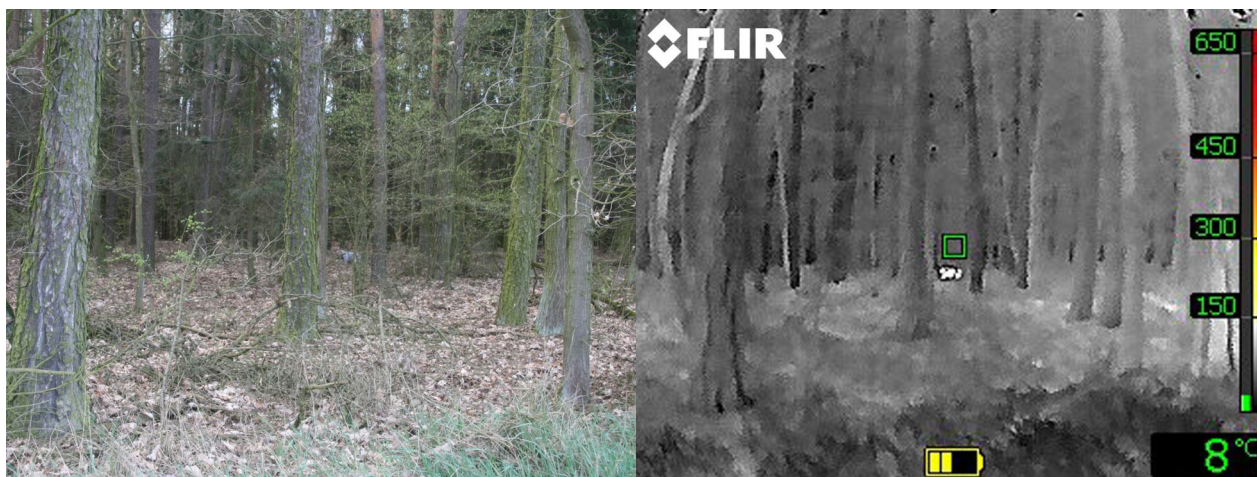
■ Fot. 57 i 58: Przykładowe zastosowanie kamery do prowadzenia poszukiwań zaginionych w lesie.
