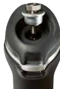
Fot. 16: Dostęp do baterii zabezpieczony śrubą. (FLIR K65)
