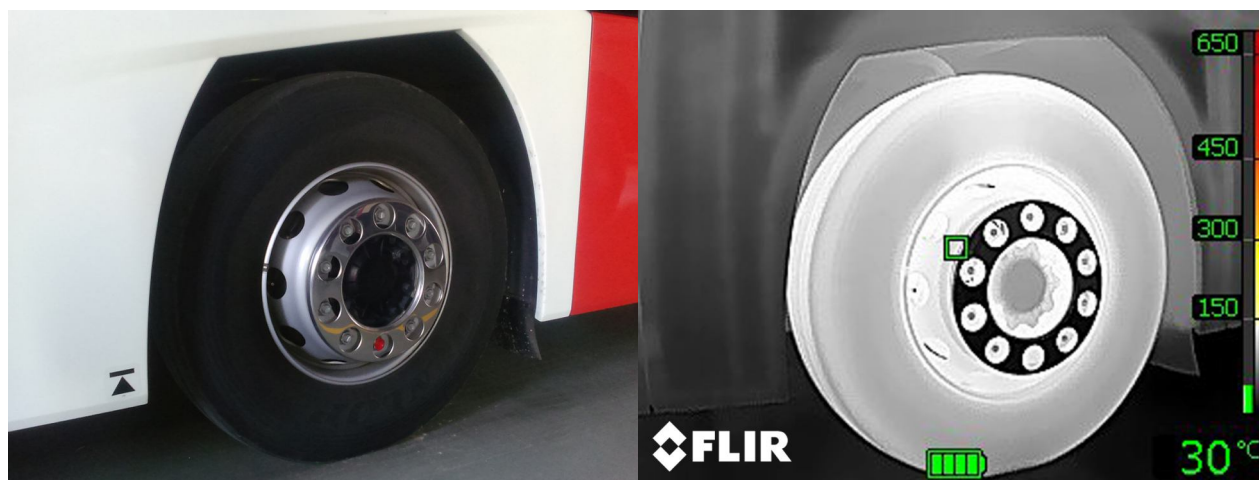
■ Fot. 53 i 54: Przykład zastosowania kamery do monitoringu nagranych elementów w pojazdach.
