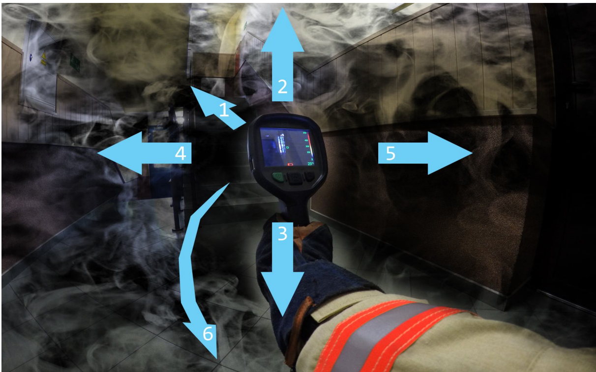
■ Fot. 18: „Rzut sześcienny” stosowany podczas poruszania się z kamerą termowizyjną w zadymionym pomieszczeniu. [Źródło: Opracowanie własne]
