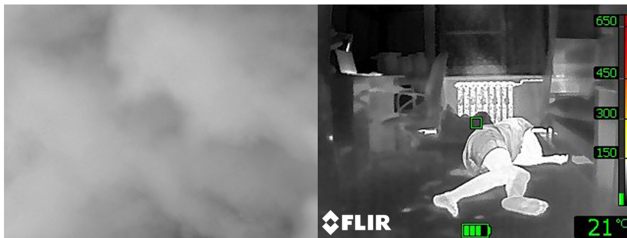
■ Fot. 30 i 31: Przykład zastosowania kamery do odszukania osób poszkodowanych w pożarze.
