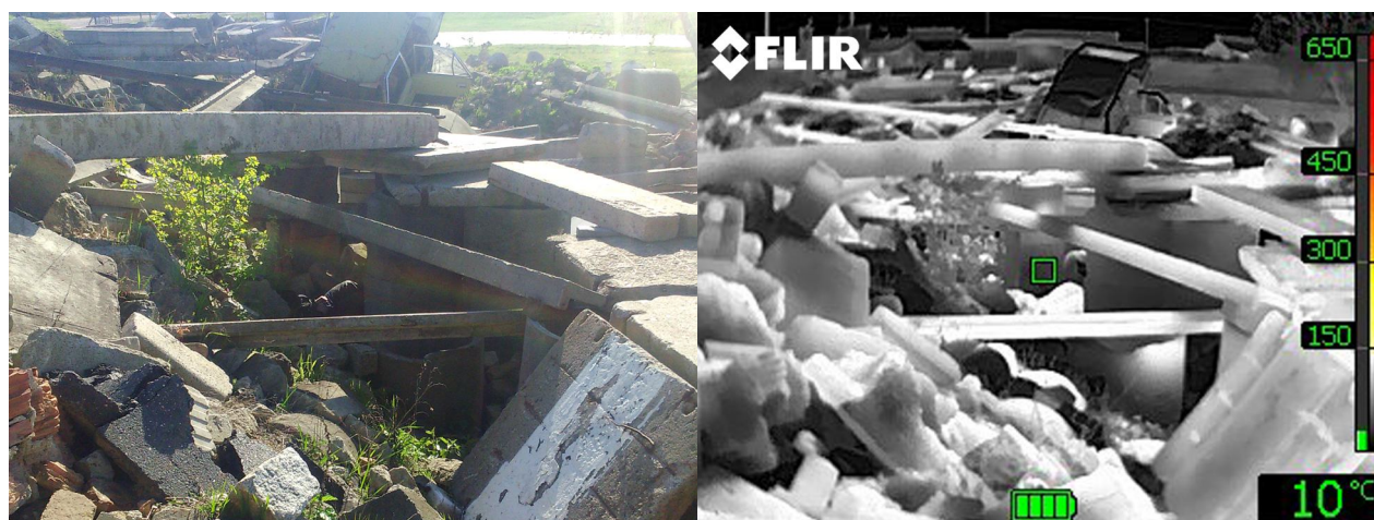
■ Fot. 61 i 62: Zastosowanie kamery IR w działaniach poszukiwawczych na gruzowisku.
