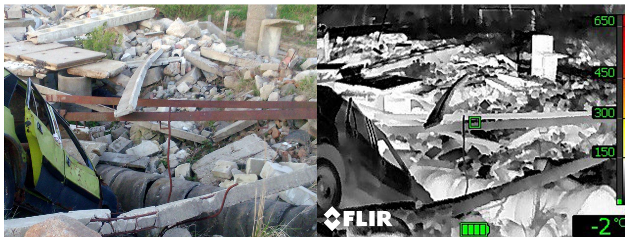
■ Fot. 63 i 64: Zastosowanie kamery IR w działaniach poszukiwawczych na gruzowisku.
