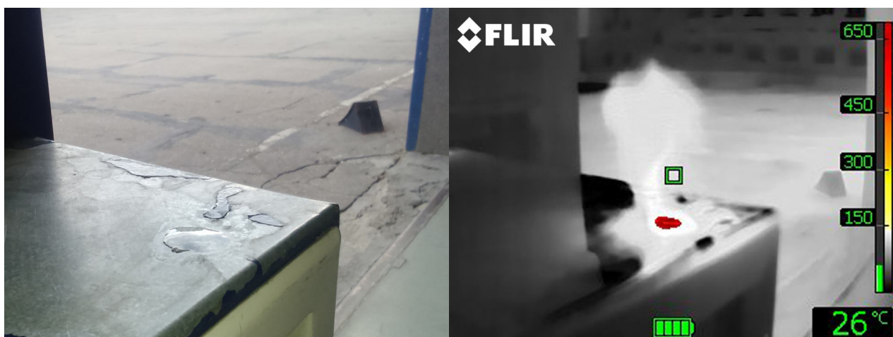
■ Fot. 46 i 47: Przykładowe zastosowanie kamery do zobrazowania płomienia substancji, spalającej się niewidocznym płomieniem.
