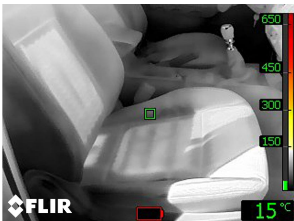
■ Fot. 52: Termogram przedstawiający widok podgrzewanych siedzeń samochodowych. (Źródło: www.flir.com)
