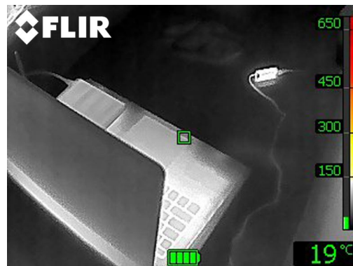
Fot. 3: Zdjęcie termalne komputera przenośnego wraz z przewodem zasilającym. Kolorystyka monochromatyczna.
