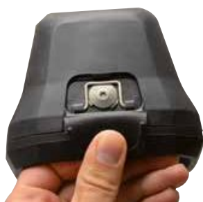
Fot. 15: Złącza kamery są w pełni uszczelnione. (FLIR K55)
