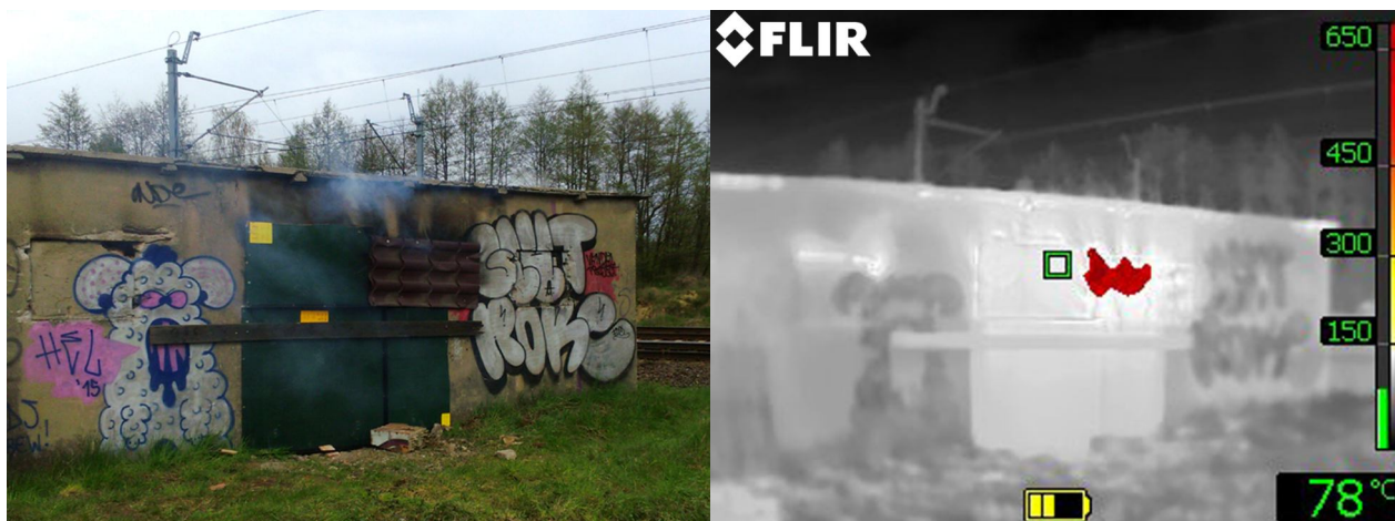
■ Fot. 24 i 25: Przykładowe zastosowanie kamery termowizyjnej przy rozpoznaniu 360 stopni. [Źródło: Opracowanie własne]
