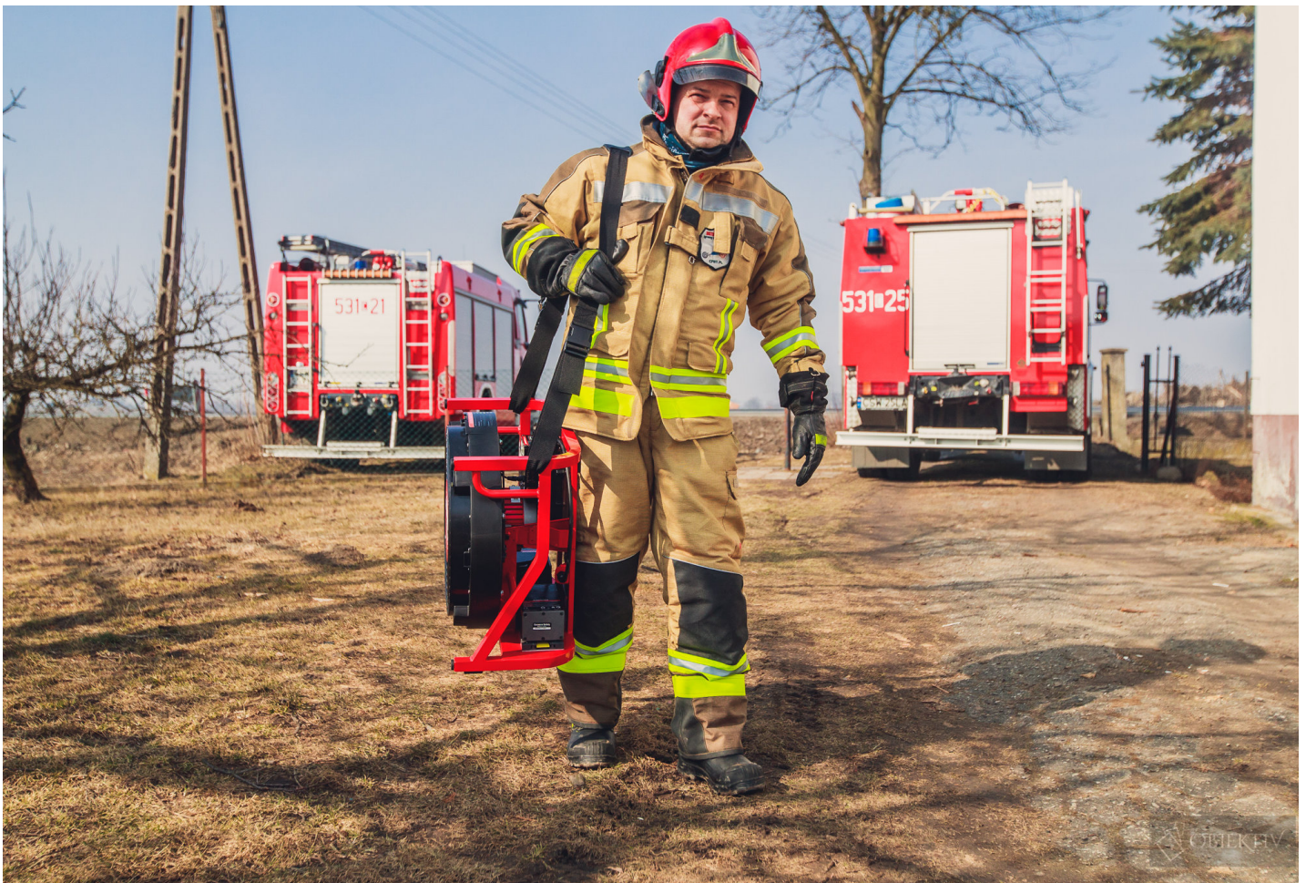
Fot. 17: Lekkie wentylatory akumulatorowe mogą być łatwo przenoszone przez jedną osobę, co ułatwia między innymi prowadzenie wentylacji sekwencyjnej.
