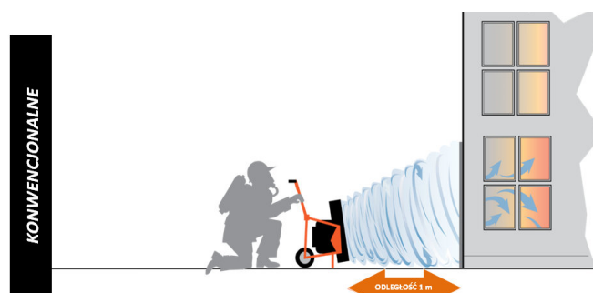
Rys. 15: Wentylatory konwencjonalne należy ustawiać w niewielkiej odległości od wlotu w celu podniesienia skuteczności, jednak wiąże się to z utrudnieniem komunikacji. Szczelne objęcie wlotu podstawą stożka wytwarzanej strugi nie jest warunkiem niezbędnym skutecznej wentylacji. [21]
