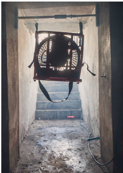
Fot. 14, 15: Wentylator nadmuchowo-wyciągowy wykorzystany do wentylacji podciśnieniowej.
