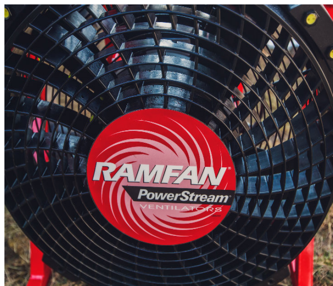
Konstrukcja elementów aerodynamicznych powodująca ukształtowanie strugi: wirnika, obudowy i kratki zabezpieczającej, tzw. „grilla”. (fot. SKG)
