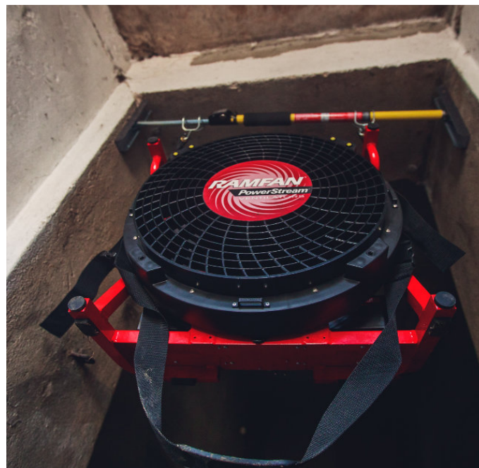
Fot. 6: Drążek pozwala na łatwe umieszczenie wentylatora (tu model Ramfan EX50Li) bliżej górnej krawędzi otworu, gdzie przepływają gorące gazy. W dolnej części może swobodnie napływać powietrze.
