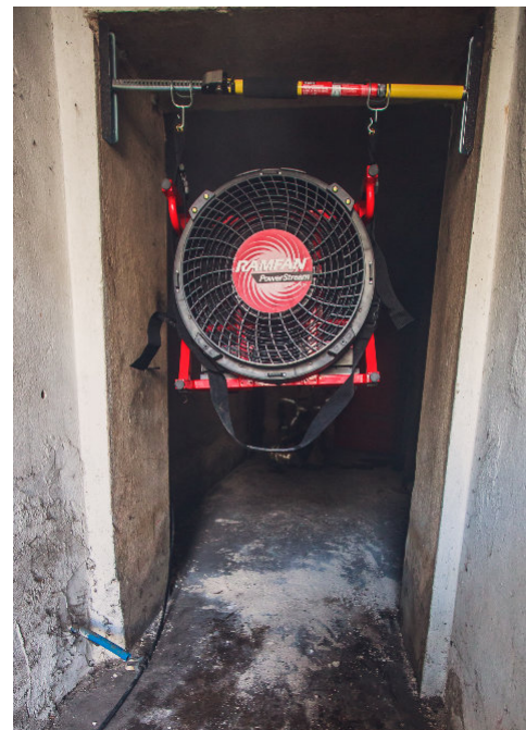
Fot. 14, 15: Wentylator nadmuchowo-wyciągowy wykorzystany do wentylacji podciśnieniowej.
