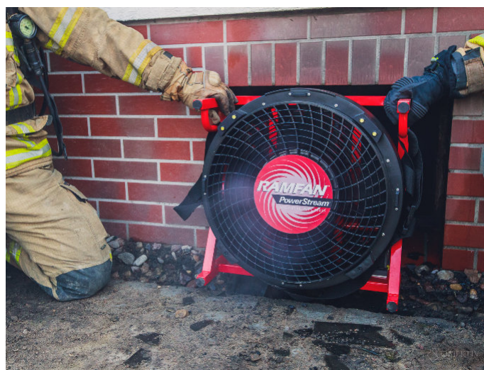
Fot. 16: Praca wentylatora wyciągowego przy usuwaniu dymu z piwnicy przez okno piwniczne.
